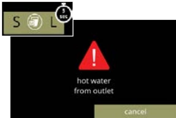
En appuyant sur S M L dans l'écran de sélection de boisson pendant 5 secondes, le rinçage rapide est immédiatement activé avec 90 ml d'eau chaude par système de mélange.
