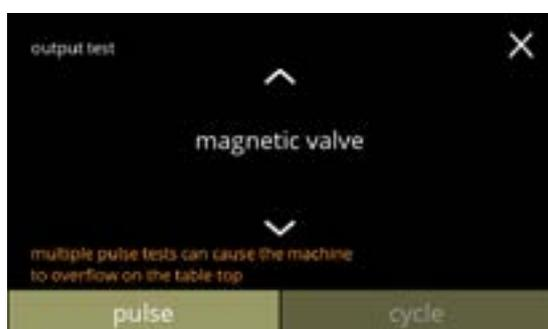
Test de vanne d'entrée magnétique :
